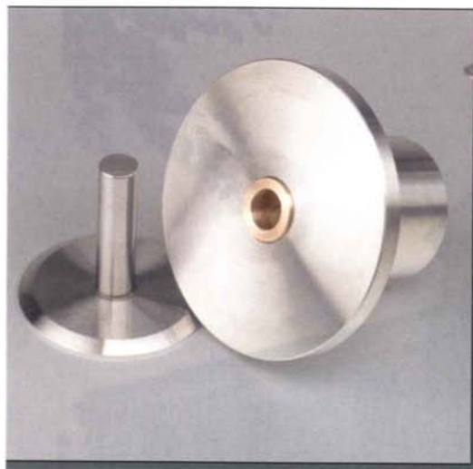
Das invertierte Ambient-Lager arbeitet mit einer gehärteten Stahlspindele und einer in einen Edelstahlblock eingelassenen Bronzebüchse
