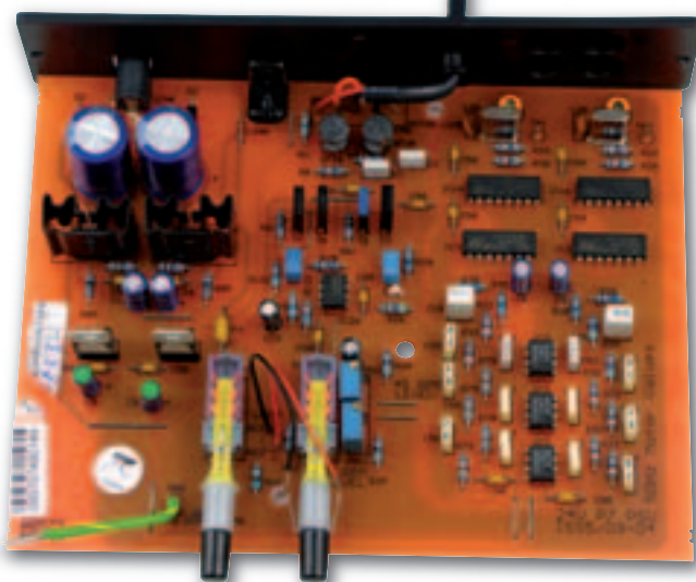
Die Motorsteuerung TTPSU glänzt mit zwei Quarzgeneratoren für 33 1/3 und 45 Umdrehungen und recht kräftigen Class-A-Endstufen.
